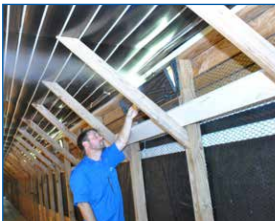
Figure 6.7 : utilisation d'un test de fumée pour déterminer si le flux d'air et la pression opérationnelle sont corrects.
