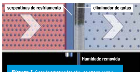
Figura 1 Arrefecimento do ar com uma serpentina e um eliminador de gotas.
