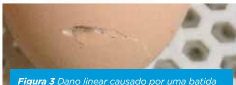
Figura 3 Dano linear causado por uma batida na barra do equipamento ou da bandeja.
