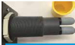
Figura 2 A foto acima mostra sensores típicos de CO 2 na incubadora, protegidos por capas. Caso as capas estejam obstruídas por poeira ou condensação, a leitura será artificialmente alta.
