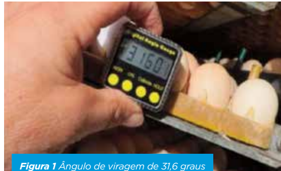
Figura 1 Ângulo de viragem de 31,6 graus é insuficiente. Objetivo é 40 à 45 graus.
