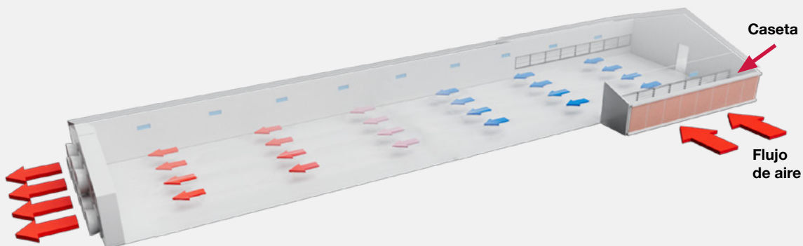
Figura 6.18 Flujo de aire en un galpón ventilado por túneles.
