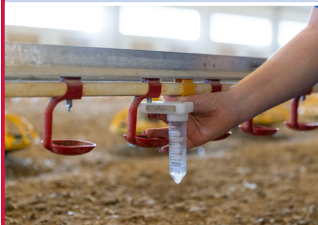
Figura 5.6 Medición de los caudales de la línea de niples.
