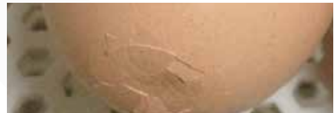
Figura 2 El exceso de presión en el sistema de vacío de los chupones del sistema de transferencia causó daño en el polo romo o mayor del huevo.
