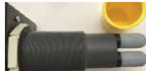
Figura 2 La foto ilustra sensores de CO 2 típicos de una incubadora, cubiertos con tapas protectoras. Si las tapas se obstruyen con polvo o condensación, el sensor producirá un valor artificial más alto del real.
